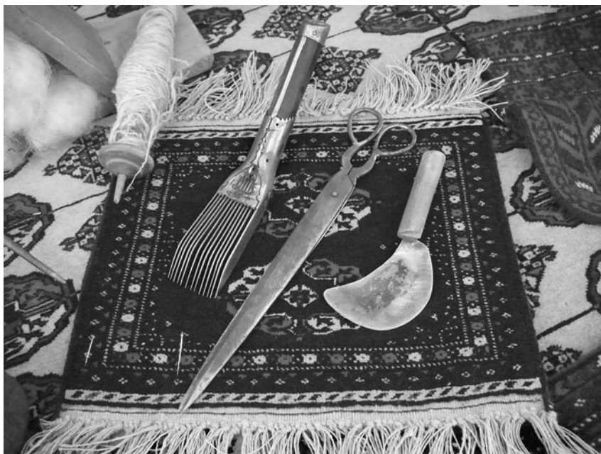
Инструменты ковровщицы: нож для отрезания концов нити, гребень-прибивалка и ножницы для стрижки ворса. 2011 г.
