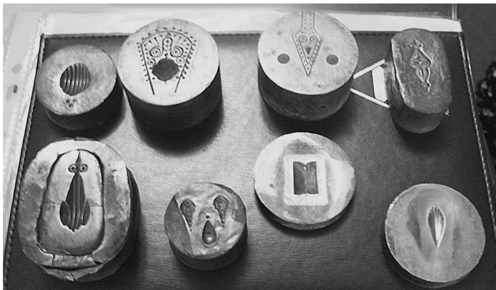
Старинные штампы для изготовления ювелирных изделий мастера М. Сахатова. 2010 г. Фото М.А. Загитовой
